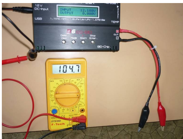
Nabíječka napojená na autobaterii jako zdroj
