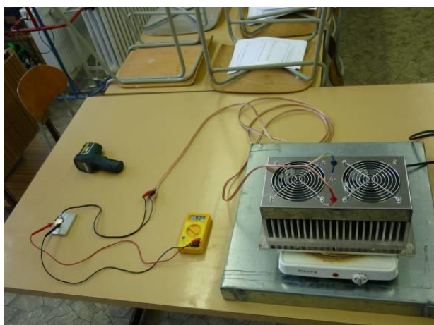
THG na elektrickém vaříči 1,5 kW
