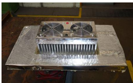
Tepelná izolace na horní straně kontaktního plechu
