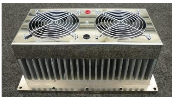
THG se vzduchovým chlazením
