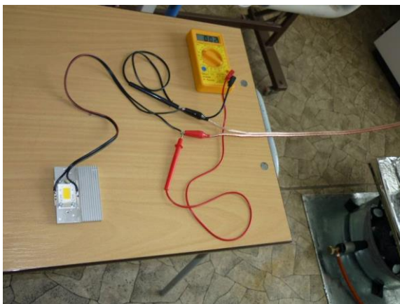
Zapojení LED – diody a multimetru
