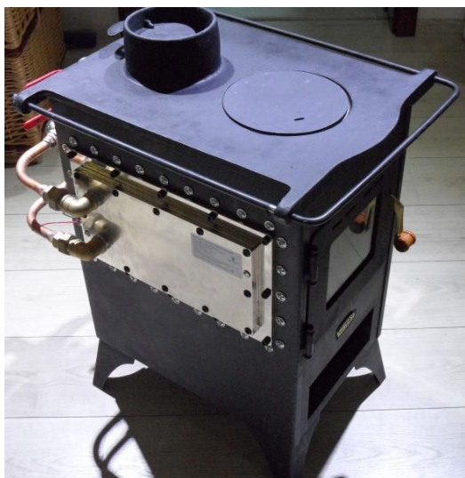
Obr: THG na kamnech – bok (celkem 2 THG) (zdroj www.towerofspirit.cz )
