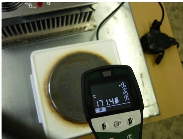
Teplota vařiče klesla pod 200 °C a bylo ji možno změřit
