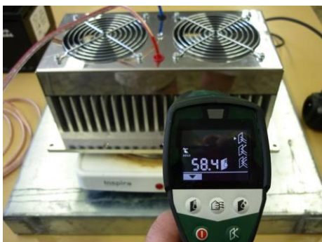
Teplota mezi žebry na kraji chladiče
