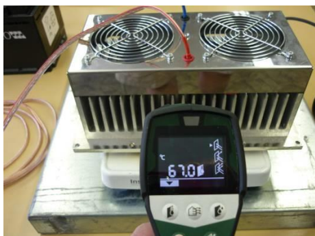
Měření teploty mezi žebry chladiče
