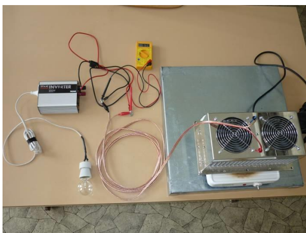
Měnič napětí připojený k THG
