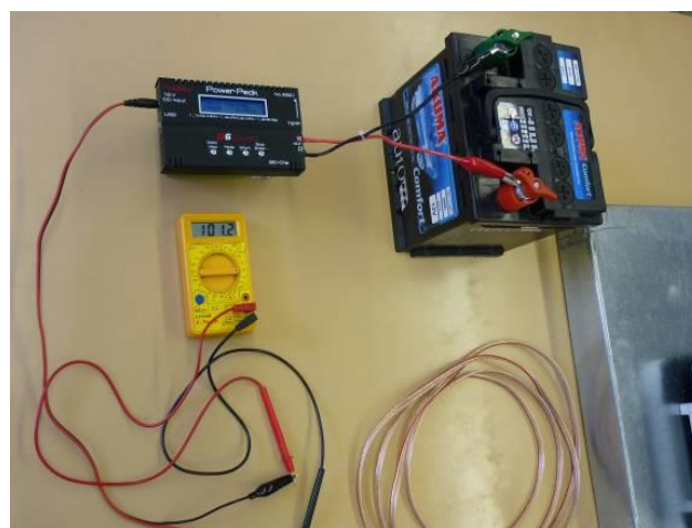
Hodnota proudu 101,2 mA na multimetru
