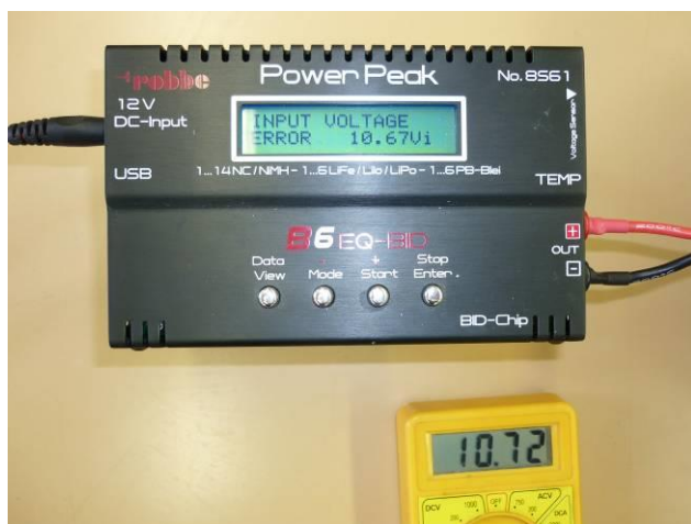
Napětí měřeno nabíječkou i multimetrem
