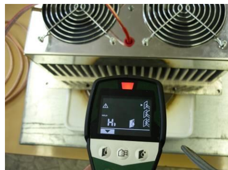
Teplota povrchu vařiče překročila 200°C – červená kontrolka teploměru hlásí měření mimo rozsah přístroje
