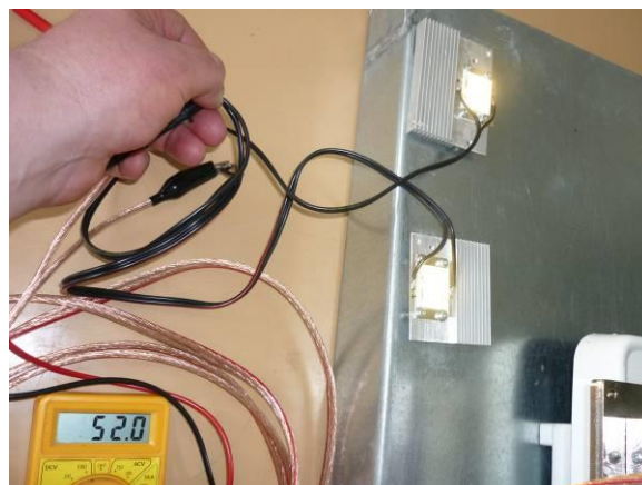
Proudový odběr diody v mA
