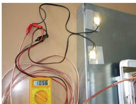
Max. dosažené napětí 10,56 V
